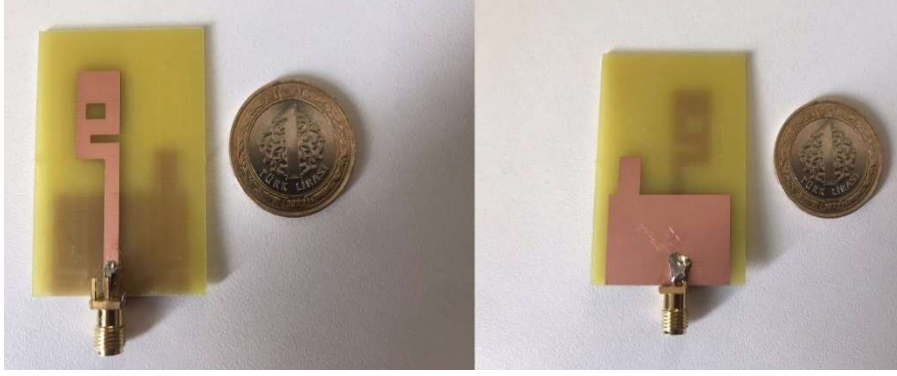
Şekil 5. 23. SMA 180C dişi konnektörle lehimlenmiş mikroşerit anten
