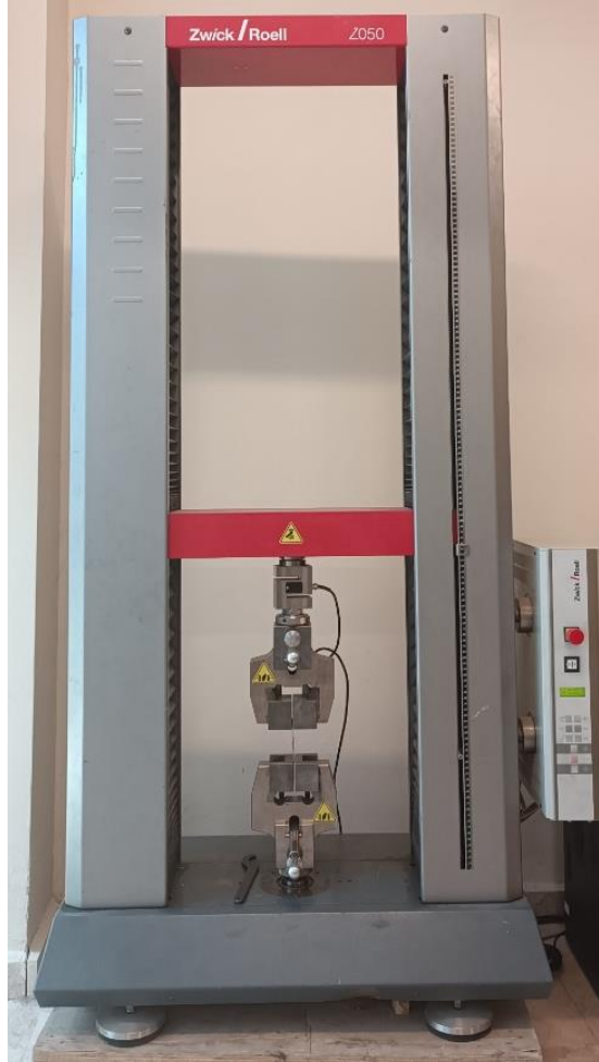
Şekil 4.8. Shear test cihazı.
