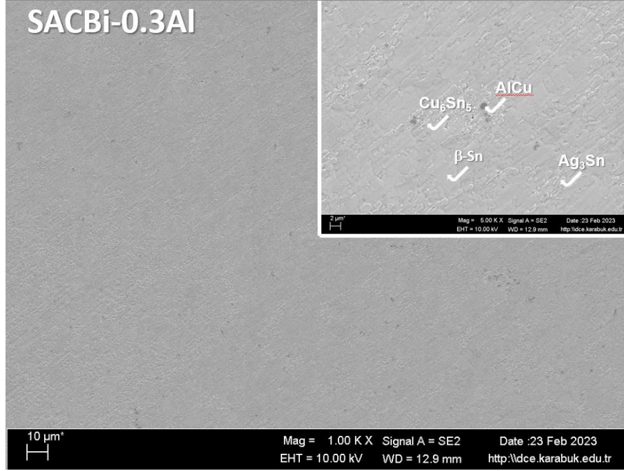
Şekil 5.40. SACBi-0,3Al lehim alaşımının mikroyapı incelemesi.
