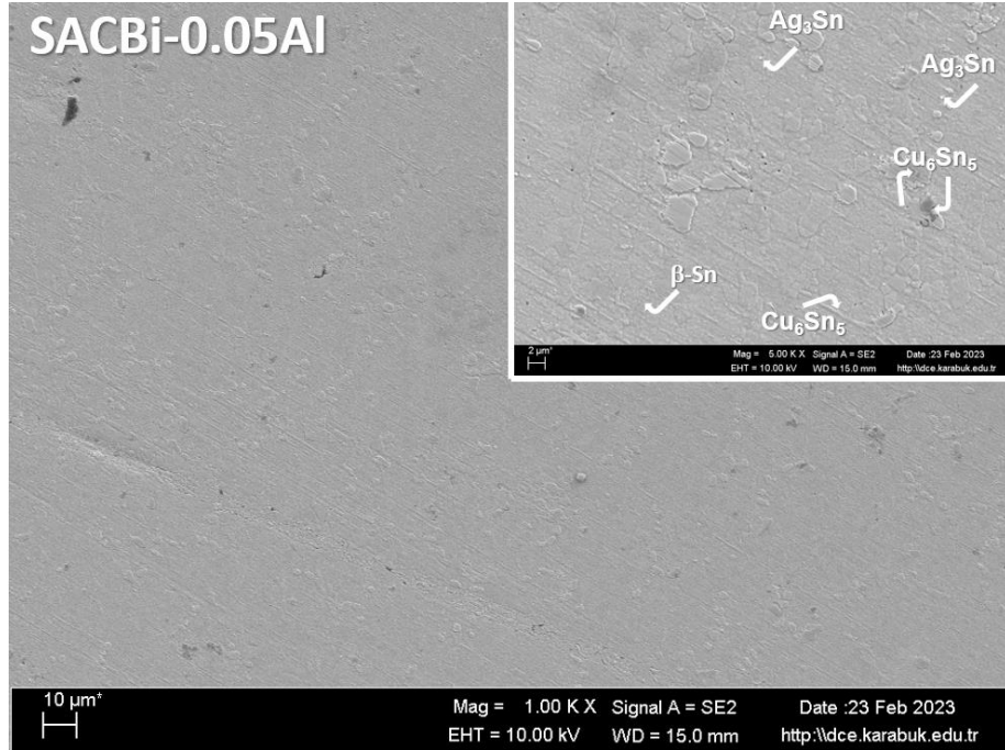
Şekil 5.38. SACBi-0,05Al lehim alaşımının mikroyapı incelemesi.
