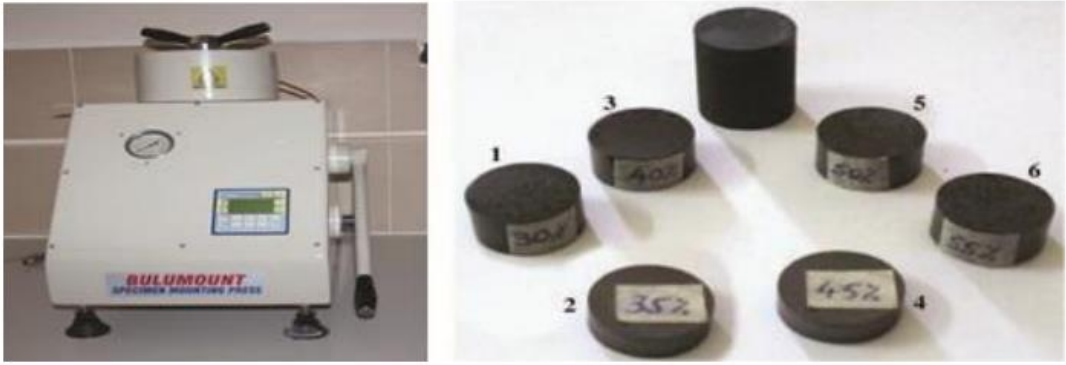
Şekil 3.9. Bakalite alma cihazı ve bakalite alınmış numuneler [21].
