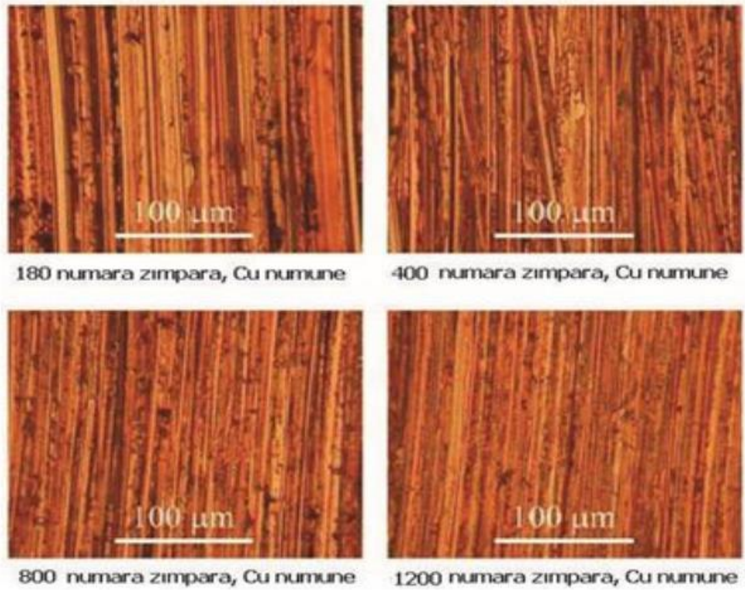
Şekil 3.12. Cu numunesi ile doğru yapılmış zımparalama işlemi [21].
