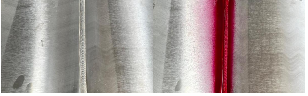
Şekil 5.9. Penetrasyon testi uygulaması a) Temizlenmiş numune b) Penetrasyon uygulanmış numune.
