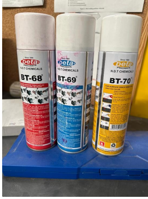
Şekil 4.7. Kullanılan penetrant sıvıları.
