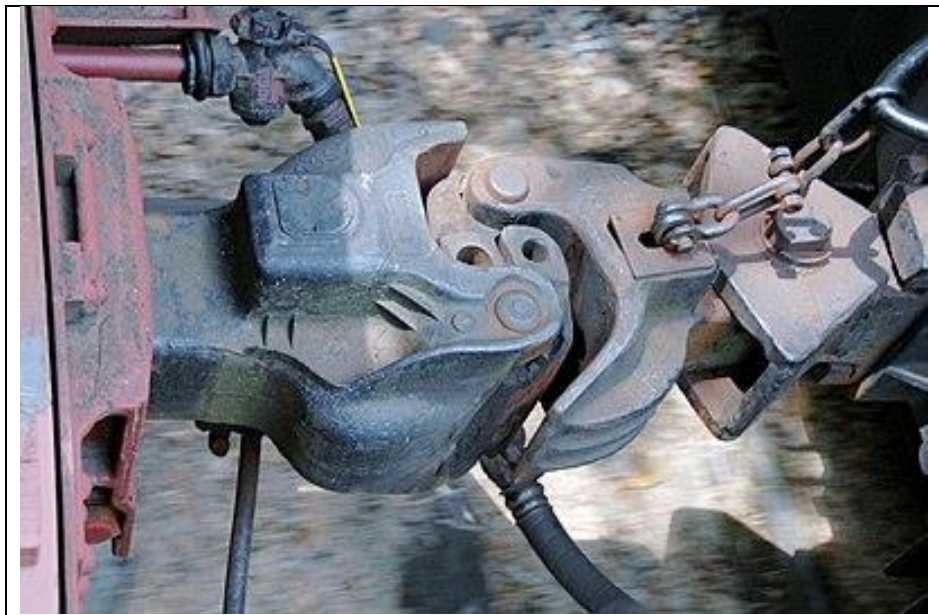
Şekil 2.11. Seyir halinde janney kuplörü.
