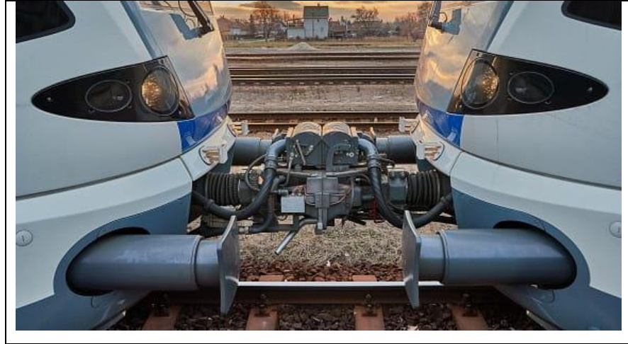
Şekil 2.16. Scharfenberg koplörü ile bağlantısı sağlanmış iki raylı sistemler aracı
