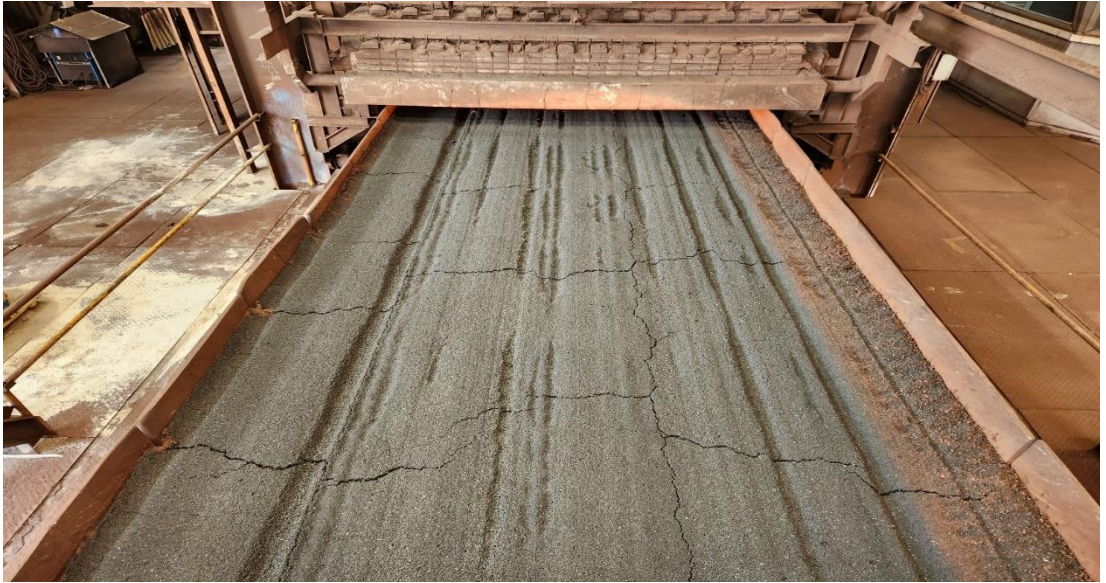
Şekil 3.8. Sinter makinasında pişirilen sinter harmanı
