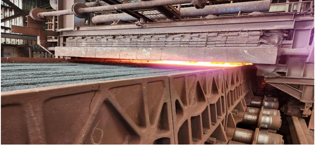
Şekil 3.7. Sinter makinasında sinter harmanının tutuşturulması
