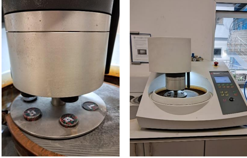
Şekil 5.4. Zımparalama ve parlatma için kullanılan polisaj cihazı
