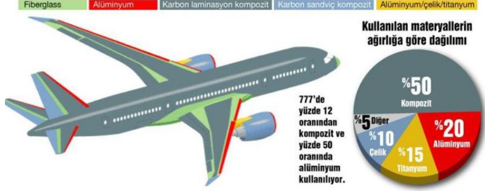
Şekil 3.1. Boeing 777 uçağında kullanılan materyallerin ağırlığa göre dağılımı [39].
