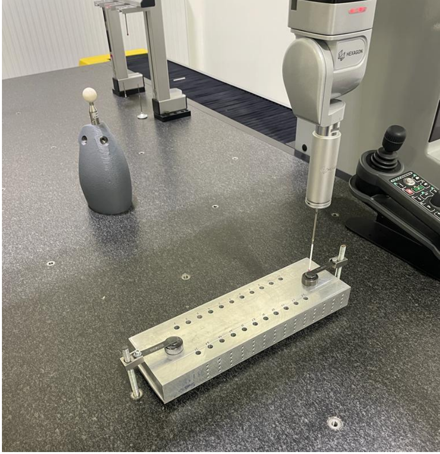
Şekil 4.3. CMM cihazı ve ölçüm düzeneği
