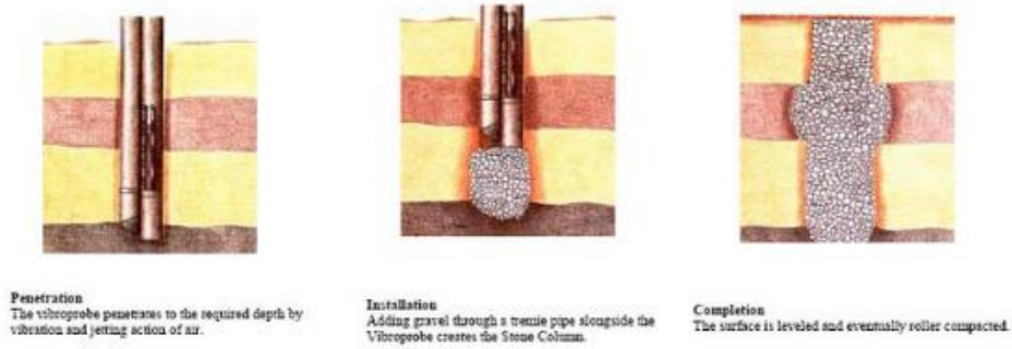
Şekil 3.9. Vibro öteleme yöntemi aşamaları [152]
