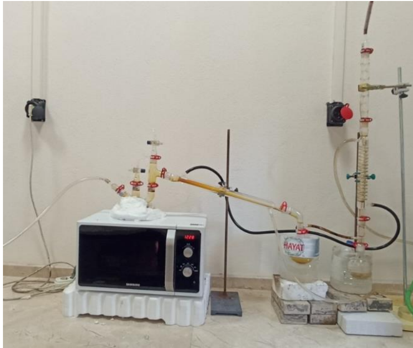
Şekil 5.5. Mikrodalga destekli piroliz düzeneği
