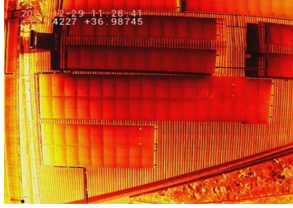
(a) Tesis batı yönüne bakan panellerin gölgeleme etkisi.
