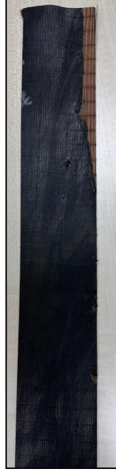
Şekil 6.9. Kaplanmamış alan olan hatalı malzeme örneği
