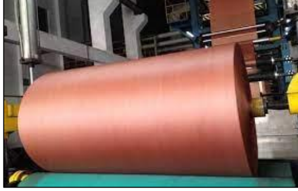
Şekil 6.4. Kauçuk kaplanmamış Kord (ip)’lu bobin örneği [149] .
