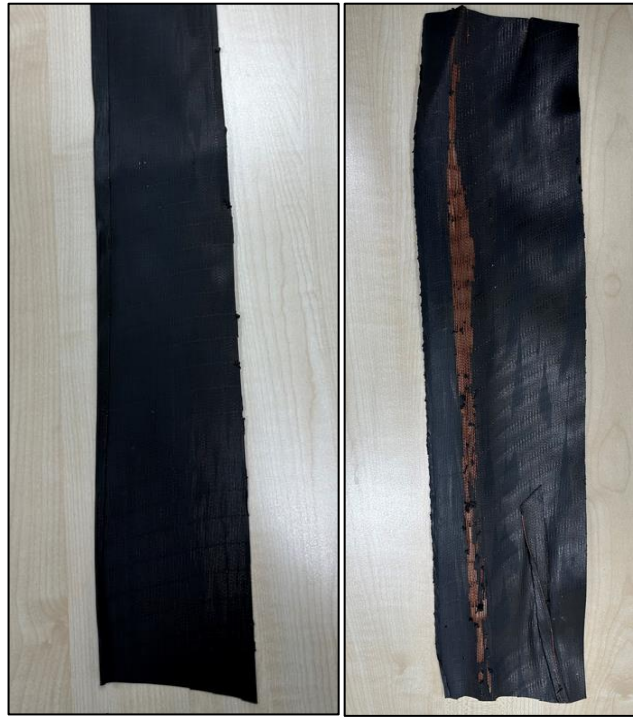
Şekil 6.6. Kaplanmış normal(solda) ve kaplanmamış (sağda) malzeme örneği
