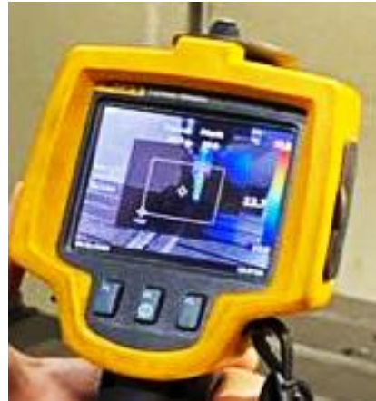
Şekil 4.2. Fluke TiS20 kızılötesi termal kamera.
