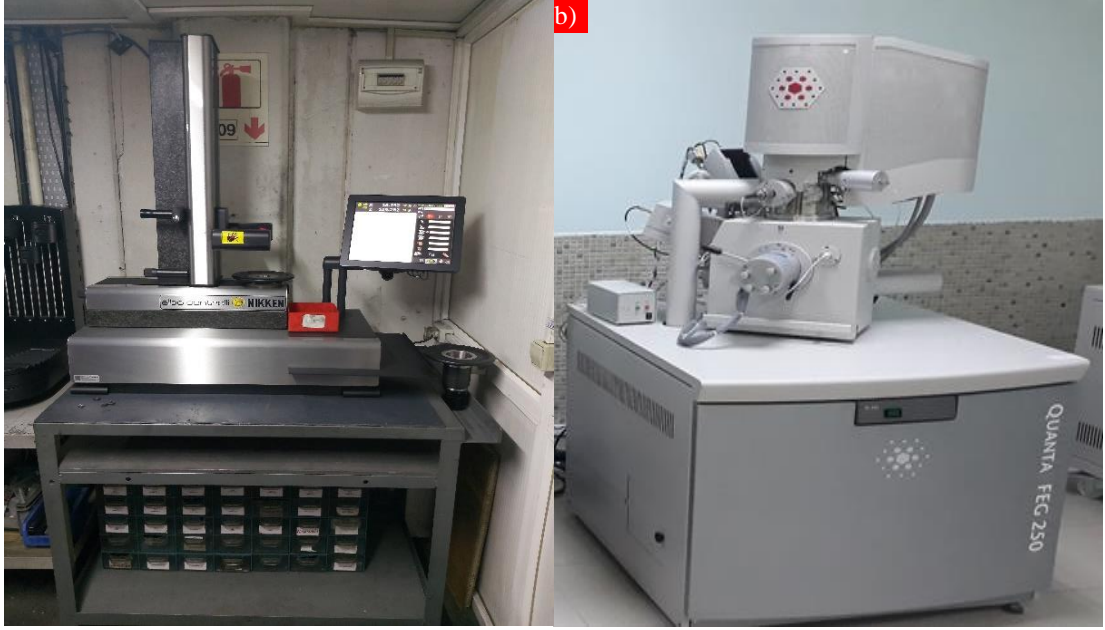
Şekil 4.4. Takım aşınma ölçülmesinde kullanılan a) dijital ve b) SEM mikroskopları.
