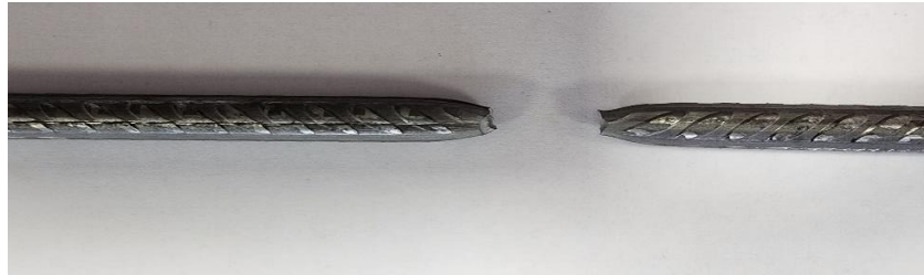
Şekil 2.15. Çubuğun boyun vererek kopması.
