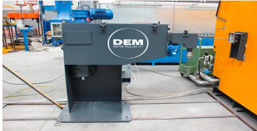
Şekil 2.16. Soğuk haddeleme öncesi sabunlama makinası genel görünümü [18].
