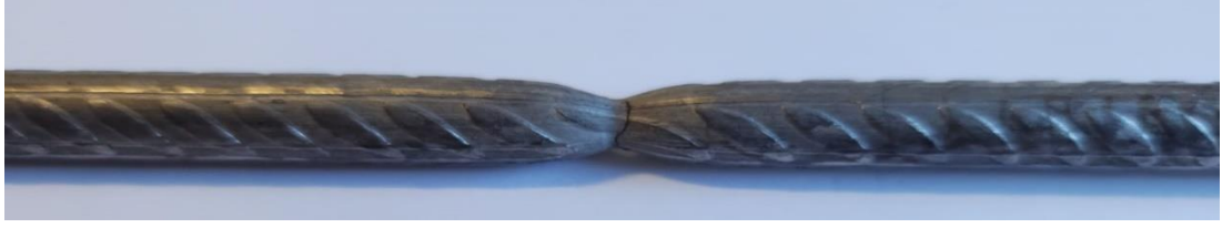
Şekil 4.3. Nervürlü hasır çubuğunun çekme testinden sonra fotoğrafı.
