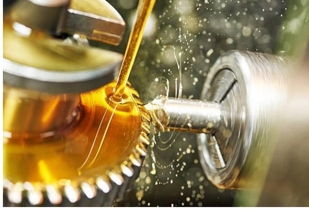
Şekil 3.1. Torna tezgahında açılan dişlinin işleme esnasında kullanılan yağlama yöntemi.
