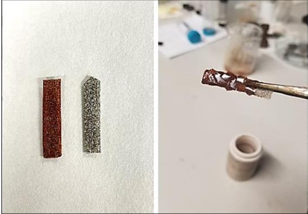
Şekil 5.2. Hidrotermal yöntemle CFO kaplama öncesi ve sonrası makro görünüm.
