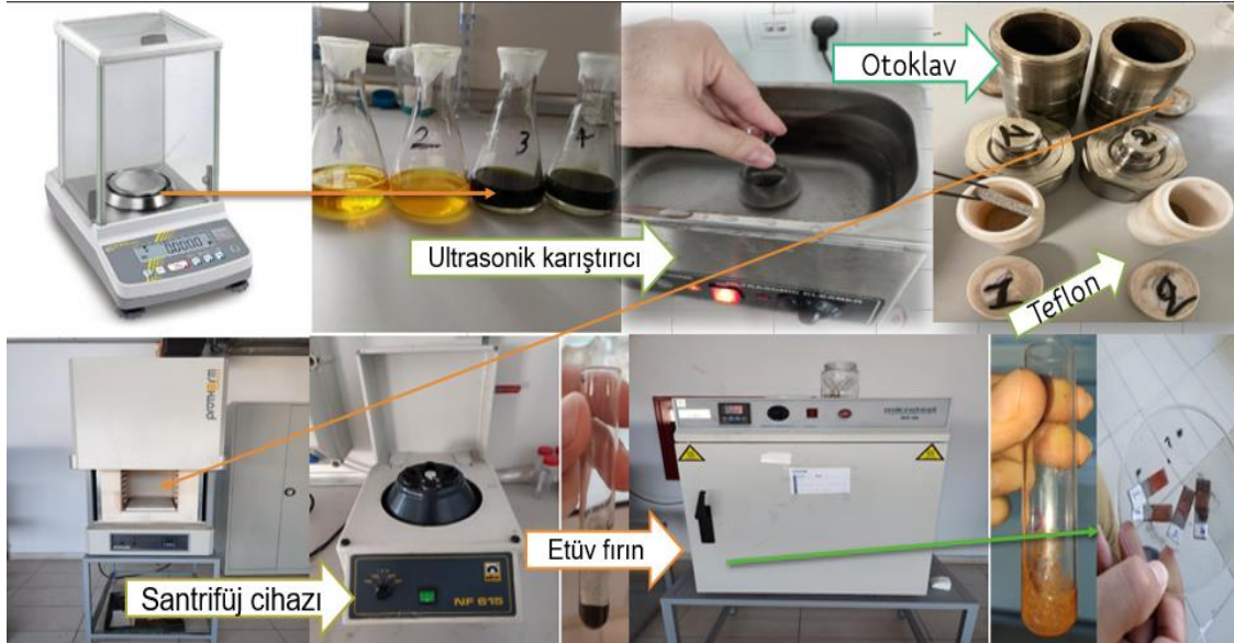
Şekil 4.2. Nikel köpük üzerinde MgFe_2O_4 ve grafen sentezi.
