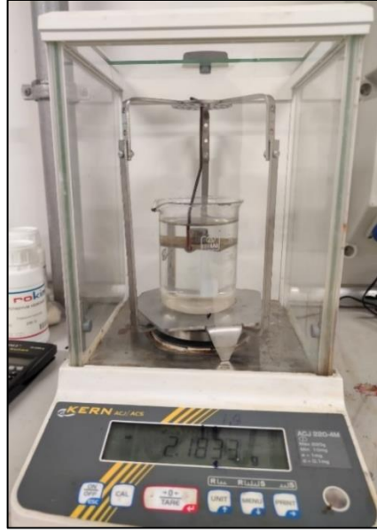
Şekil 4.8. Arşimet prensibi ile yoğunluk ölçme kiti.
