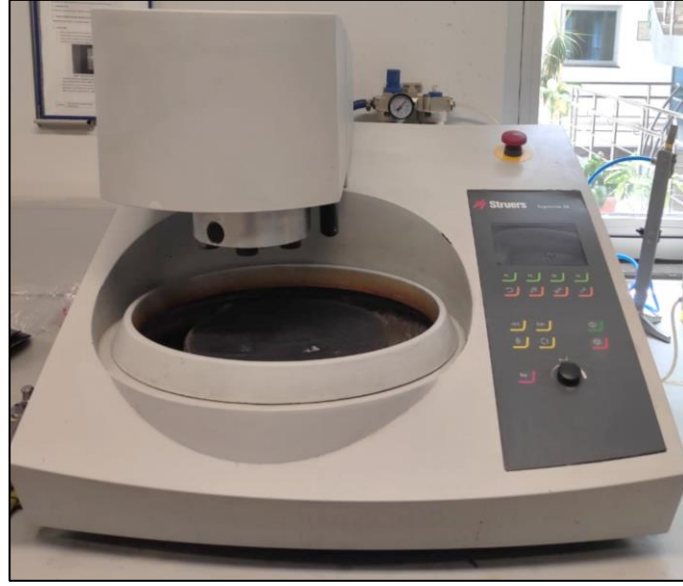
Şekil 4.7. Zımparalama ve parlatma cihazı (Struers Tegramin 30).
