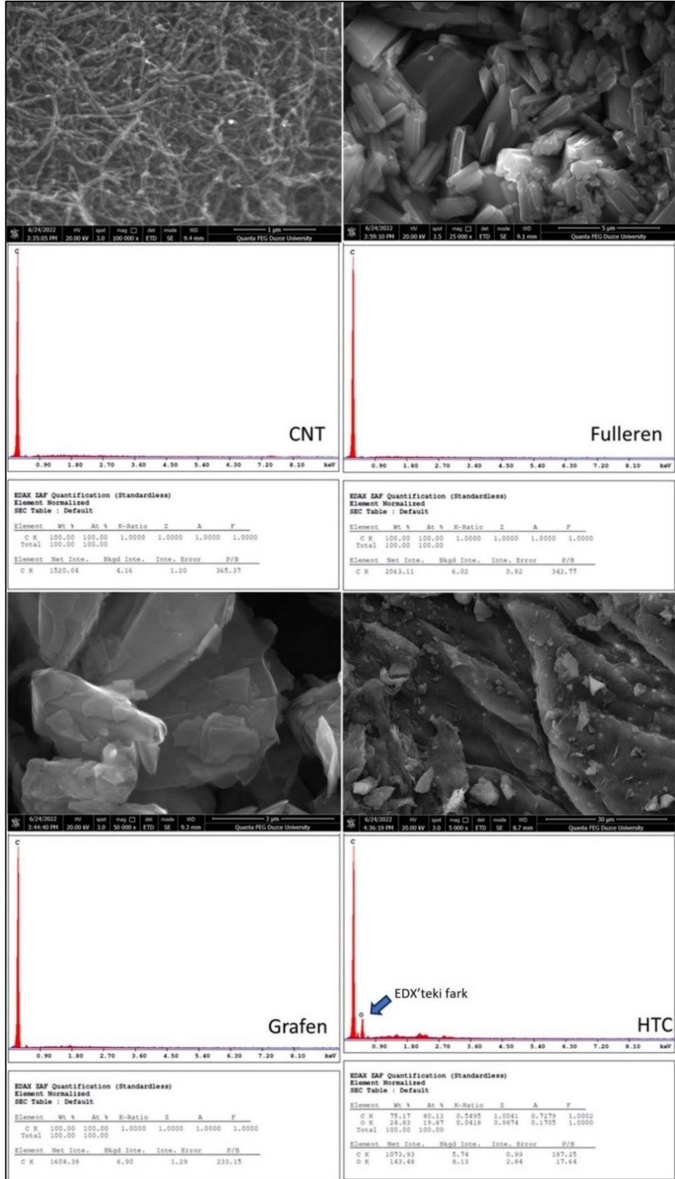
Şekil 7.1. HTC ve diğer vasıflı karbonların SEM görüntüleri ve EDX analizleri.
