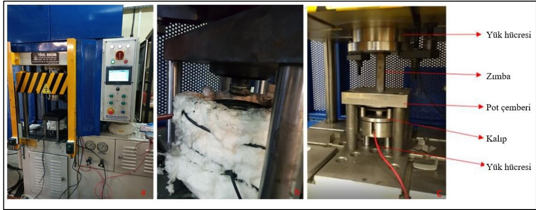
Şekil 6.4. Derin çekme ünitesi a) ve yalıtılmış kalıp sistemine b) ait resimler c) bileşenler.
