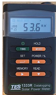
Şekil 3.13. Işınım ölçer cihazı.
