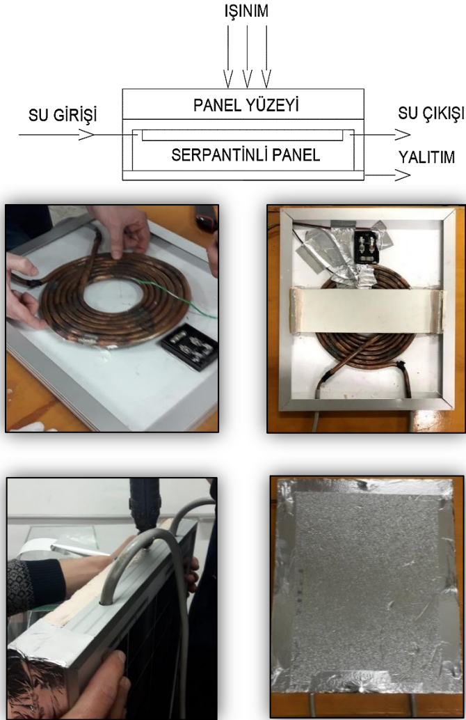
Şekil 3.4. Geliştirilen serpantinli su soğutmalı panelin (SRP) imalatı ve montajı.
