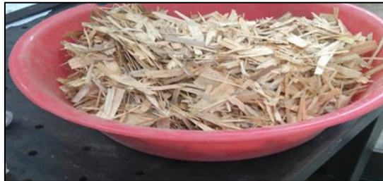
Şekil 4.4. OSB levhaların üretiminde kullanılan yongalar.
