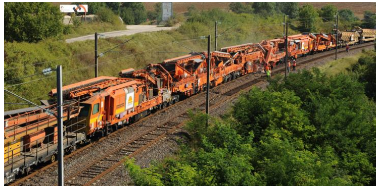
Şekil 9. Plasser&Theurer şirketince üretilmiş balast temizliğinde kullanılan OTM
