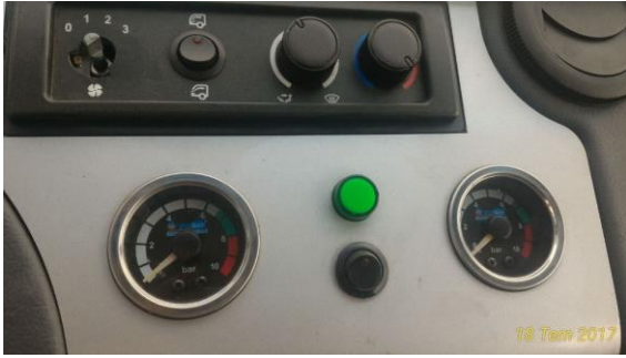
Ana fren hattı basıncı ve ana depo basıncı için basınç göstergeleri
