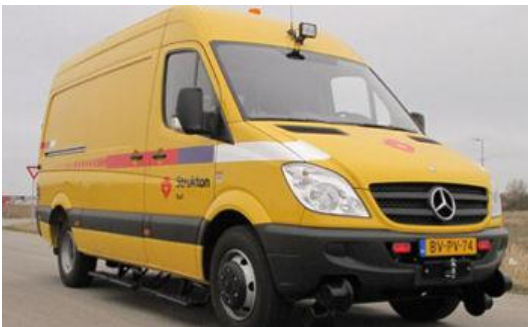
Elektrifikasyon/sinyalizasyon işlerinde kullanılan mobil demiryolu aracı
