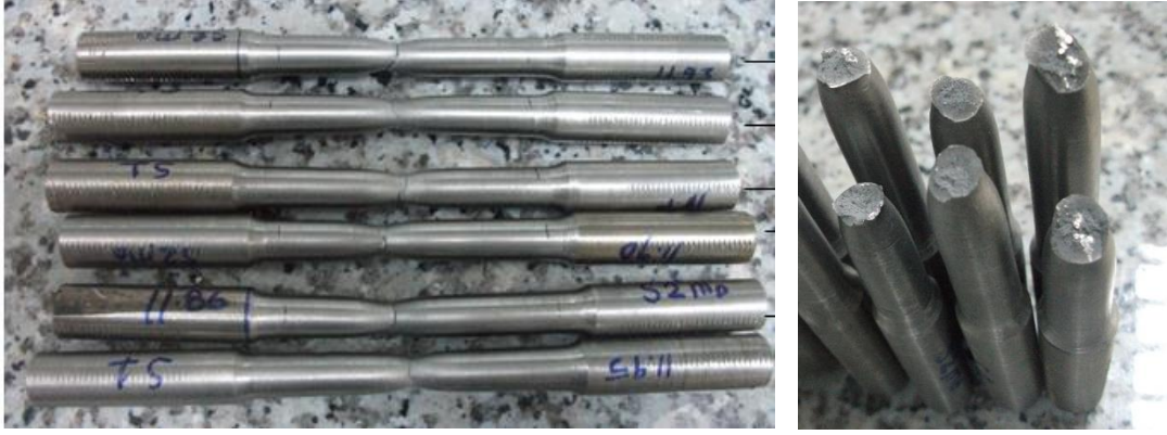
Şekil 12. Kopmanın gerçekleştiği bölgeler.
