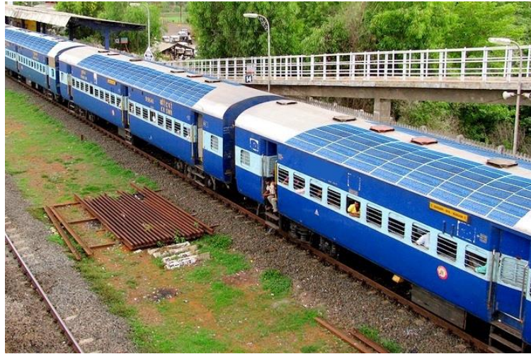
Şekil 2.7: Güneş enerji paneli yerleştirilmiş demiryolu aracı.
