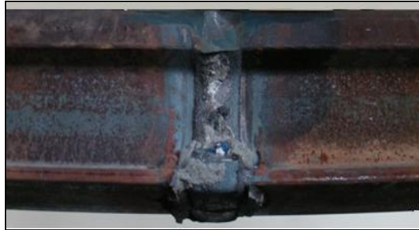
Şekil 3. Yorulma deneyi sonrası kaynaklı numune
