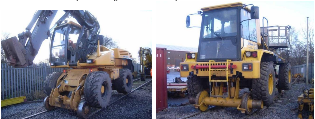
Şekil 6. Kategori 9B mobil demiryolu aracına örnekler (Frenleme ve tahrik/çer lastik tekerleklerle yapılmaktadır)
