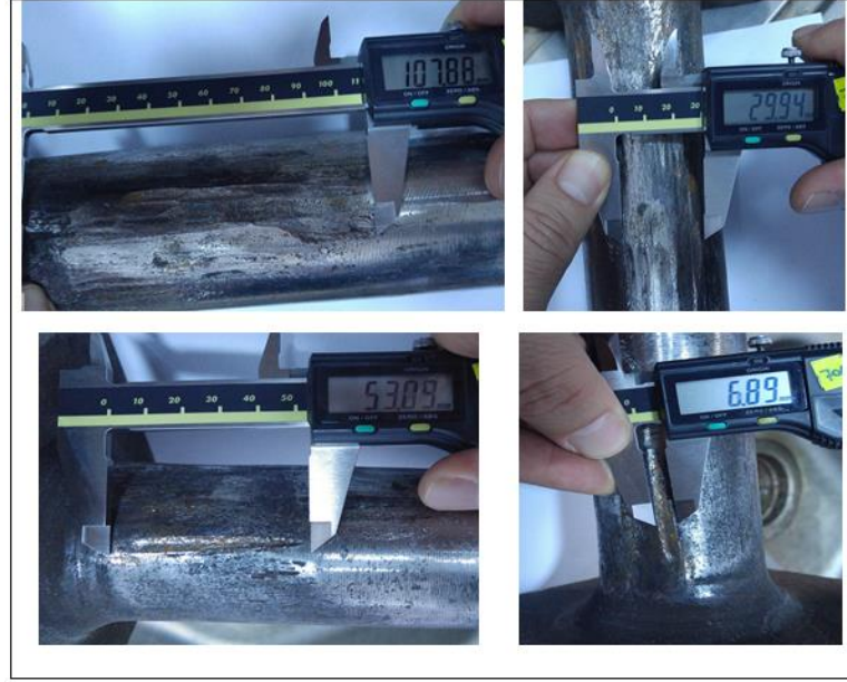
Şekil 2. Kanca Yüzeyinde görülen sürtünme izleri, ezilmeler
