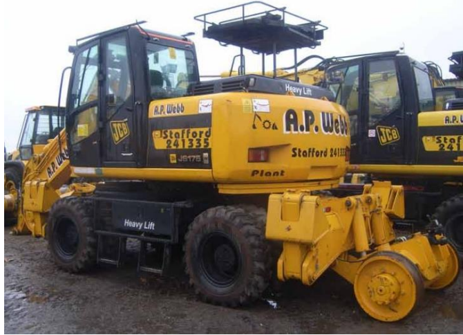
Şekil 4. Kategori 9A mobil demiryolu aracına örnek (Demiryolu tekerlekleri tahriklidir)
