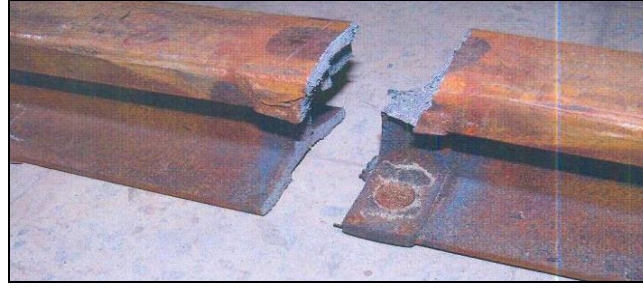
Şekil 4. Eğilme deneyi sonrası kaynaklı numunenin yakından görünüşü
