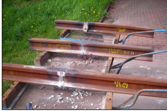
Şekil 1. Statik eğilme testi için hazırlanan kaynaklı numuneler
