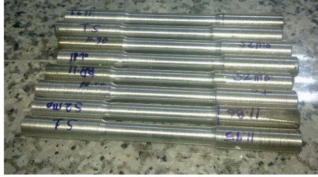
Şekil 8. Silindirik çekme numunelerinin kaynaklı parçalardan çıkarılması ve çekme test görüntüleri (TS EN ISO 6892-1 Mart 2011).
