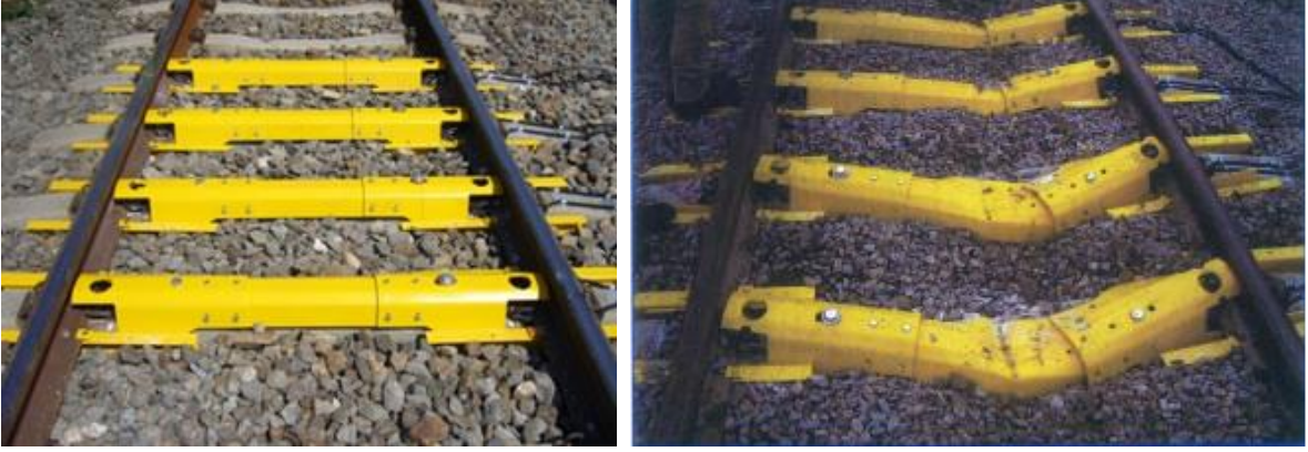
Şekil 7. Traverslerin üzerine monte edilen kuvvet algılayıcı sensörler
