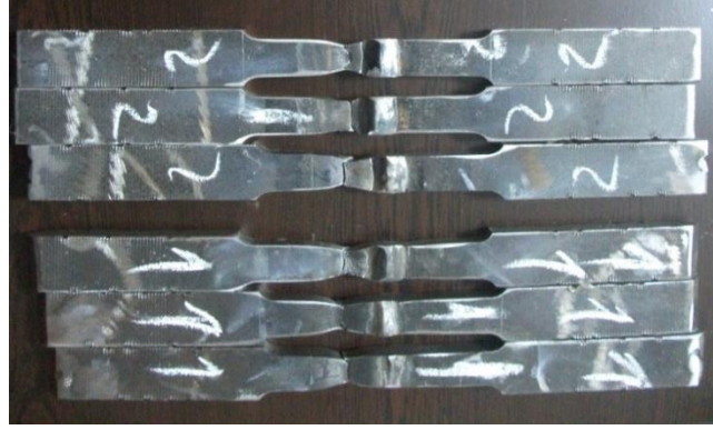
Şekil 10. Çekme testi sonucu koparılan numune fotoğrafları.
