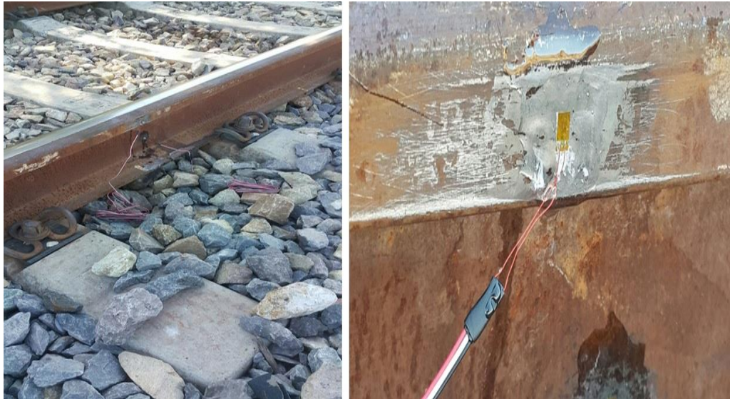
Şekil 2. Raylara yapıştırılan gerinim ölçerlere ait görüntüler
