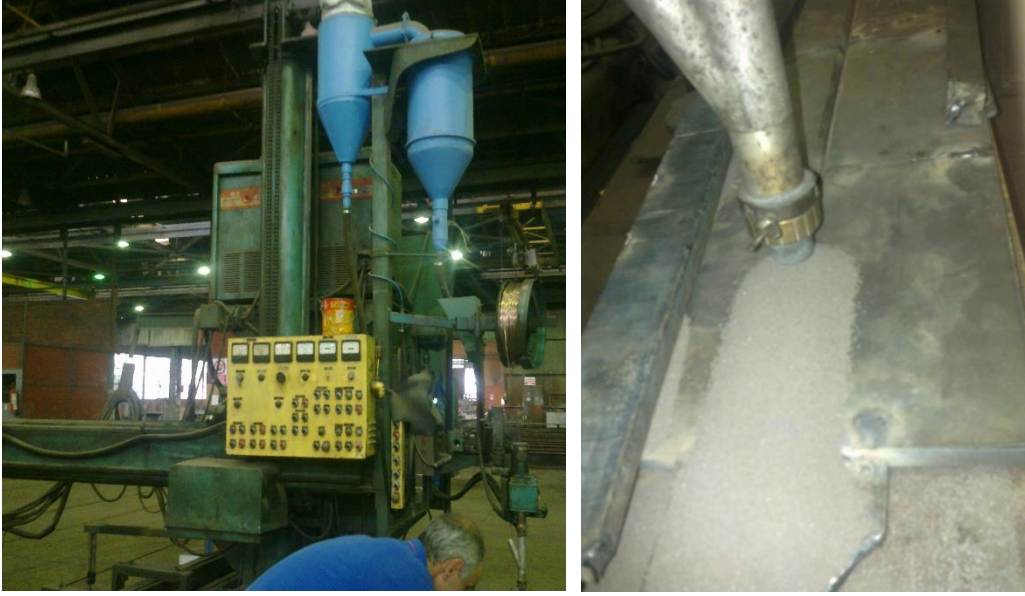
Şekil 2. Kaynak işleminin yapıldığı Lincoln marka tozaltı kaynak makinası Tablo 4. Tozaltı kaynak makinesinin teknik özellikleri.
