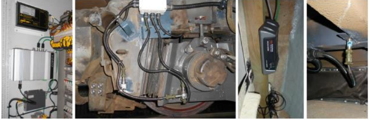
Şekil 4. İvme sinyalleri vasıtasıyla hat durumunu izlemeye yönelik sistemin bileşenleri
