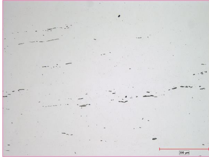
řekil 2. ND 100X Silika, slfr, almina ve oksit kalıntıları
