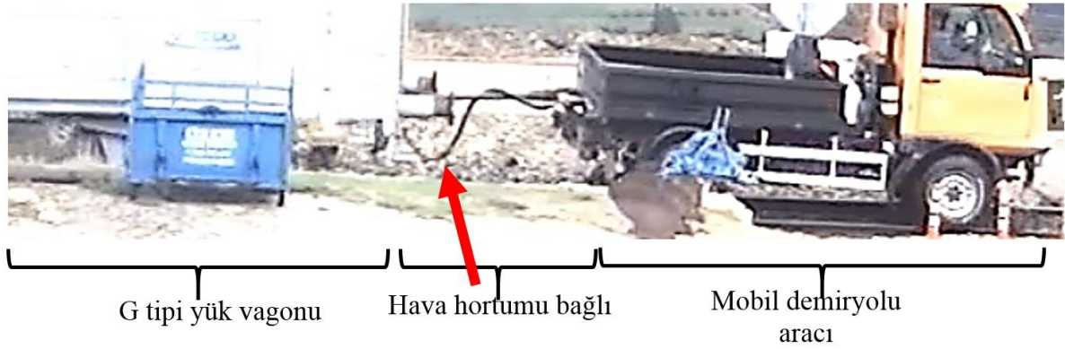
Şekil 13. Kaza geçiren trende mobil demiryolu aracı ve G tipi vagon arasındaki bağlantı
