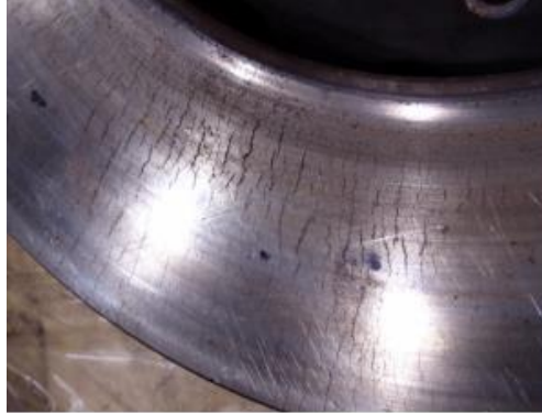
Şekil 1. Sürtünme halkası yüzeyinde termal çatlakların meydana geldiği bir raylı araç fren diski [1].
