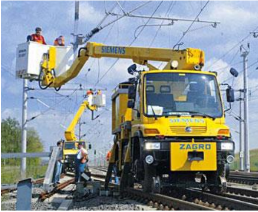
Elektrifikasyon/sinyalizasyon işlerinde kullanılan mobil demiryolu aracı
