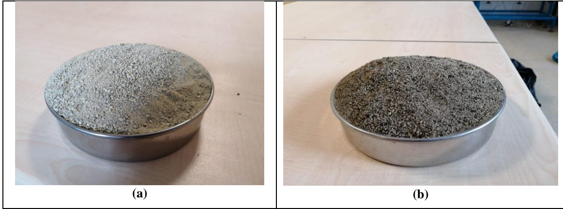
Şekil 1.(a) Granüle edilmiş yüksek fırın cürufu, (b) GeoPLAS firmasından temin edilen ham Bentonit.
