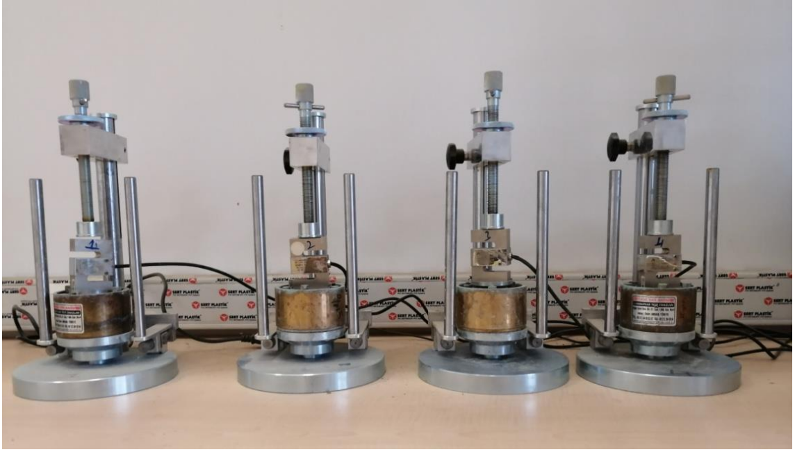
Şekil 6. Serbest şişme ödometre deney aleti.
