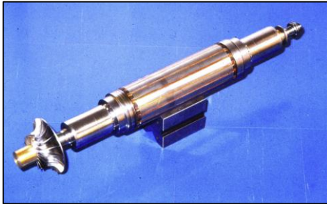
Şekil 5. Jeneratör ve besleme pompalı radyal türbin, 1984[10].
