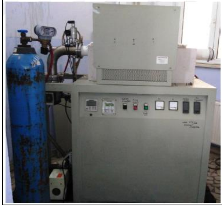
Şekil 5.5. Sinterleme işlemlerinin yapıldığı vakumlu ısı işlem sinterleme fırının görüntüsü.
