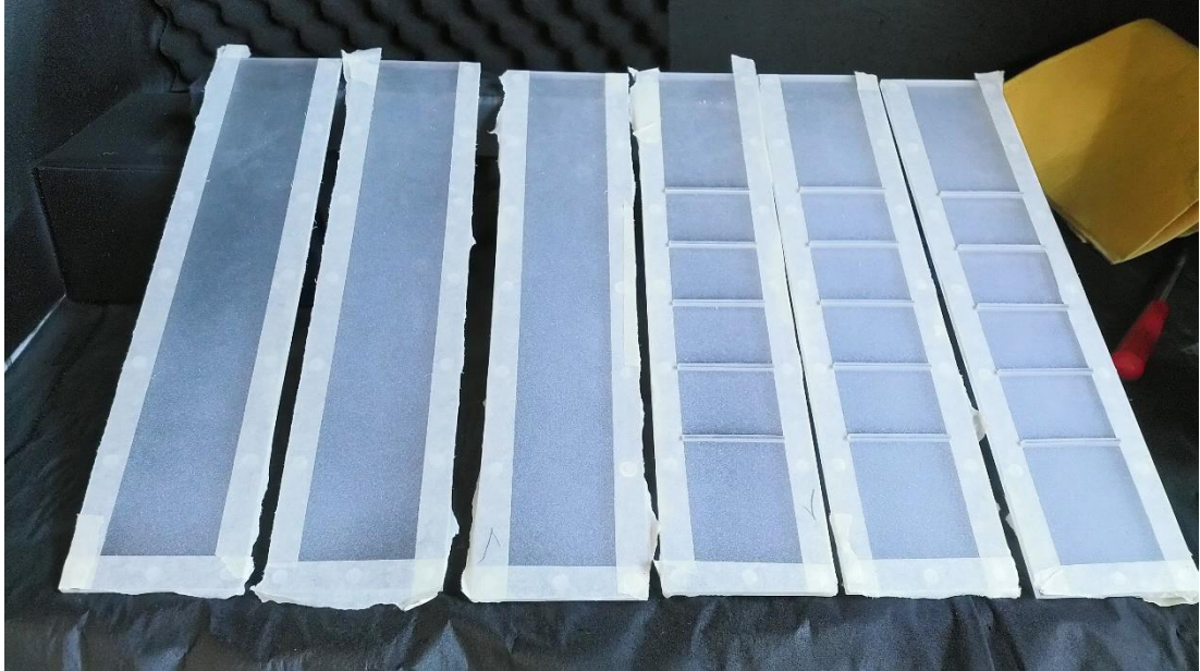
Şekil 3.10. Sıvı kristal ile boyanmış hedef yüzeyler.
