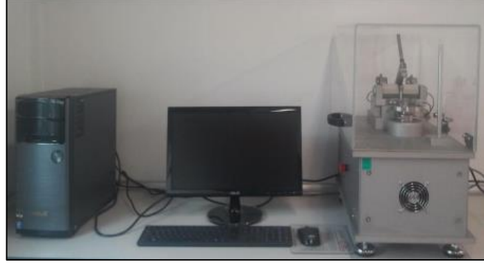
Şekil 5.9. UTS Tribometer T10/20 aşınma cihazı.
