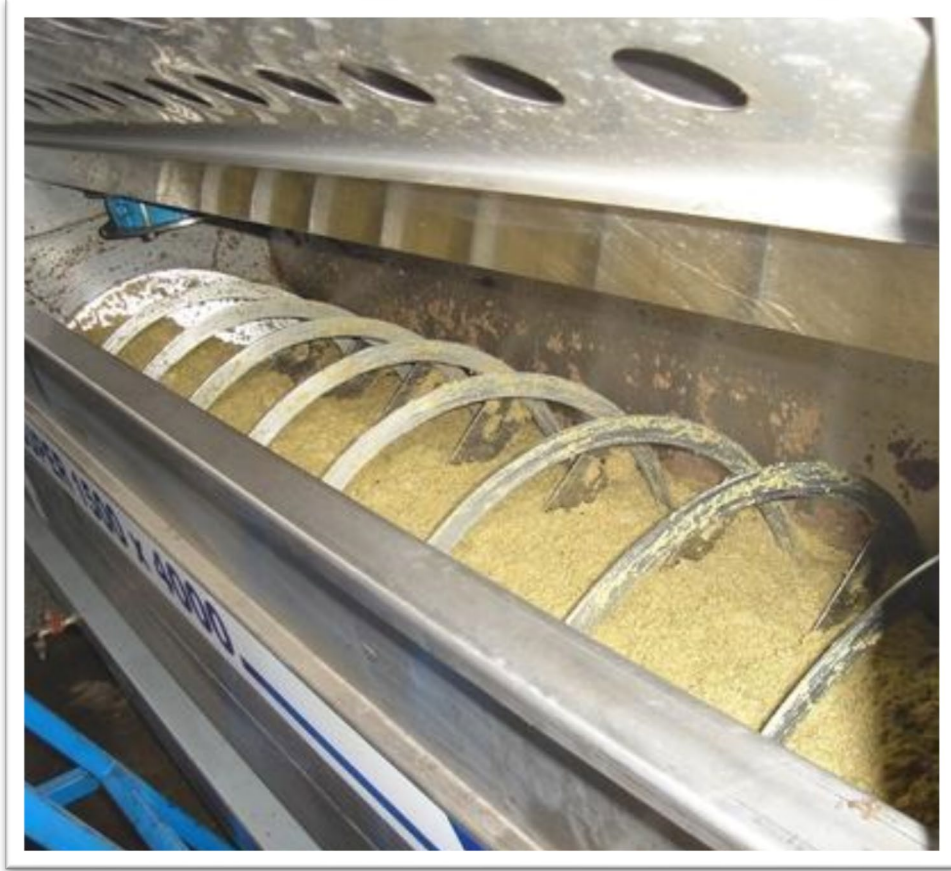
Fotoğraf 2. Malaksör’de Karıştırılan Zeytin Hamuru
