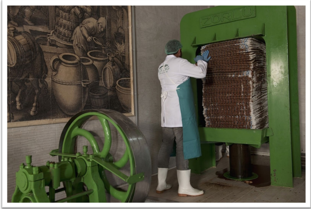
Fotoğraf 7. Zeytin Hamuru ile Doldurulan Torbaları Presleme İşlemi
