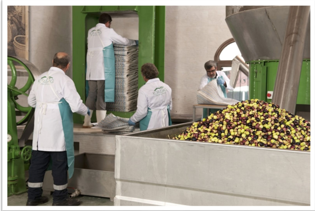
Fotoğraf 6. Zeytin Hamurunu Kanaviçe Torbalarına Doldurma ve Hizama İşlemi
