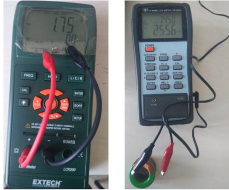
Şekil 5.16. Direnç ve bobin elemanların ölçülmesi.
