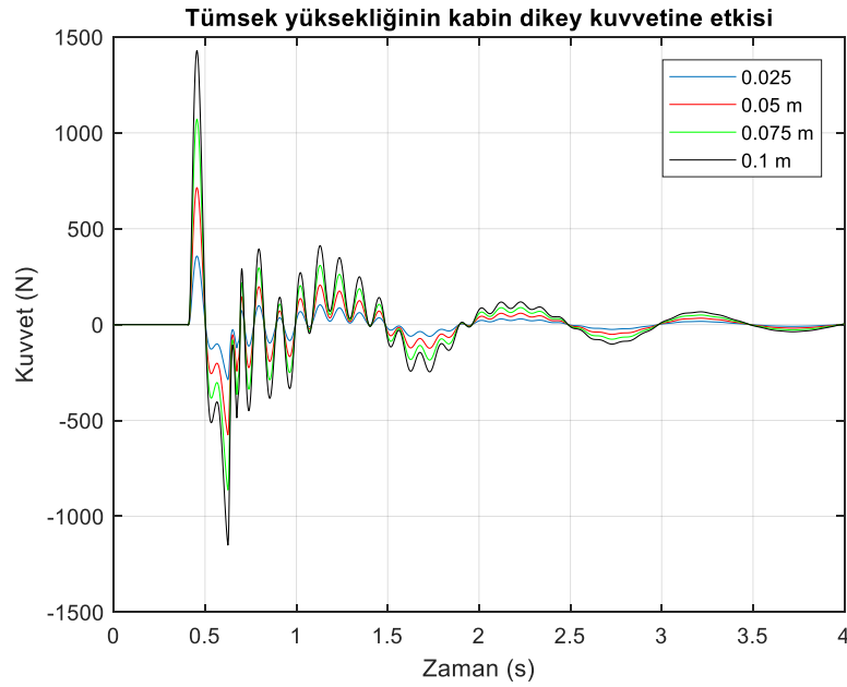
Şekil 6.151. Kamyon kabinine dikey yönde etki eden kuvvetler.
