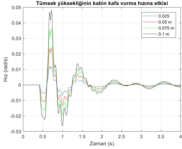
Şekil 6.160. Kamyon kabininin kafa vurma yönündeki hızı.
