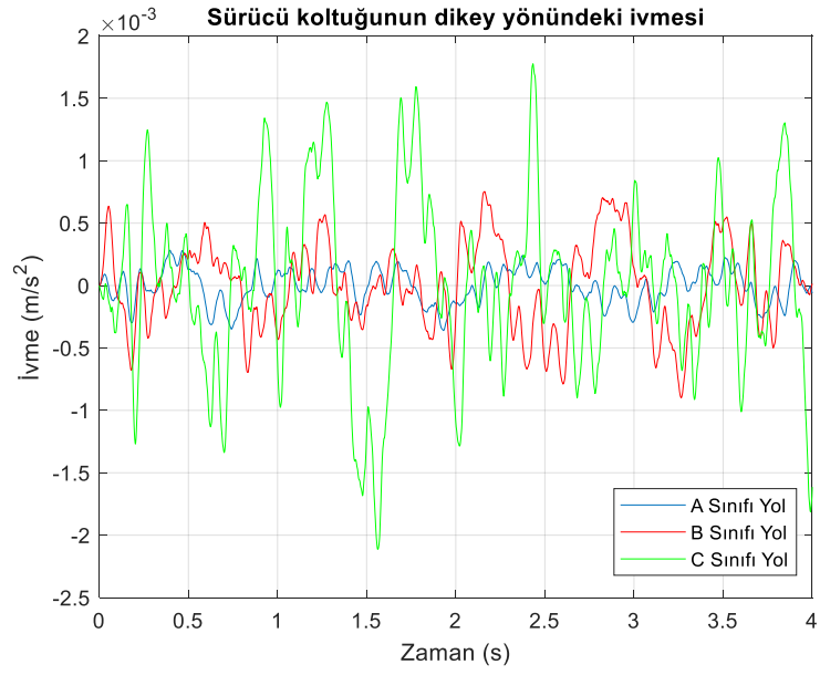
Şekil 6.16. A, B, C sınıfı yol pürüzlülüğünde sürücü koltuğunun dikey yönündeki ivme grafikleri.
