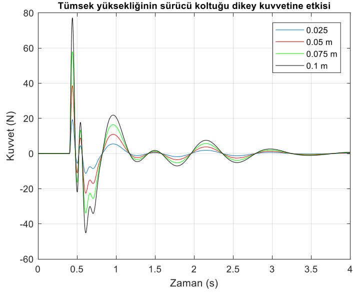
Şekil 6.36. Tek tümsek yol profilinde sürücü koltuğuna etki eden dikey yöndeki kuvvetler.
