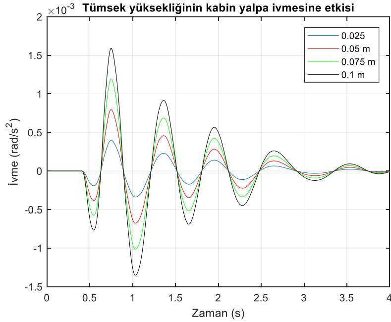
Şekil 6.167. Kamyon kabininin yalpa yönündeki ivmesi.
