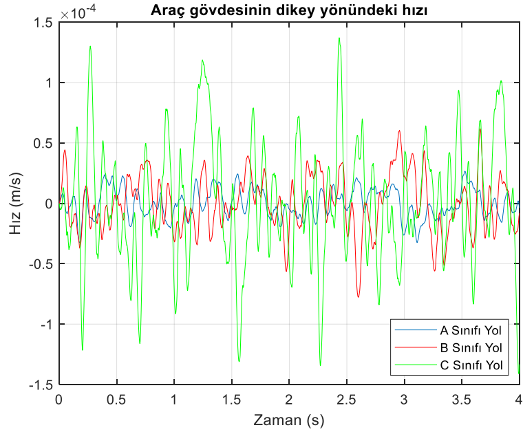
Şekil 6.13. A, B, C sınıfı yol pürüzlülüğünde araç gövdesinin dikey yönündeki hız grafikleri.
