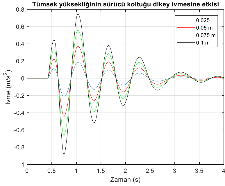
Şekil 6.146. Kamyon sürücü koltuğunun dikey yönündeki ivmesi.
