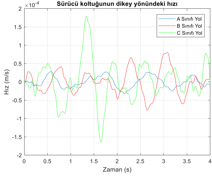
Şekil 6.12. A, B, C sınıfı yol pürüzlülüğünde sürücü koltuğunun dikey yönündeki hız grafikleri.
