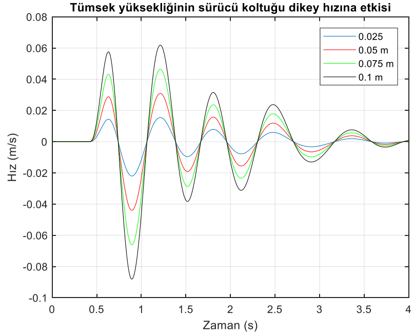
Şekil 6.142. Kamyon sürücü koltuğunun dikey yönündeki hızı.
