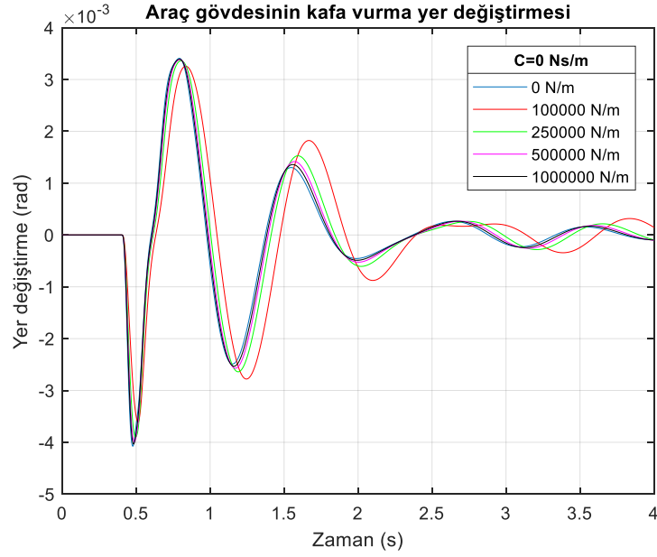
Şekil 6.90. C=0, yol yaylanmasının araç gövdesinin kafa vurma yönündeki yer değıştirmesine olan etkisi.
