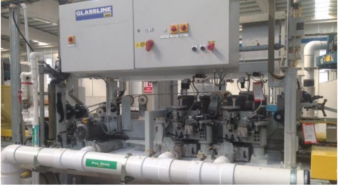
Şekil 6.5. Glassline kenar işleme makinesi.
