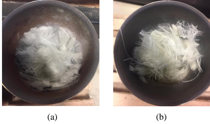
Şekil 7.1. (a) Kalın kesitli CTP kompozitlerden çıkarılan ve (b) ince kesitli CTP kompozitlerden çıkarılan cam elyafların görünüşleri.
