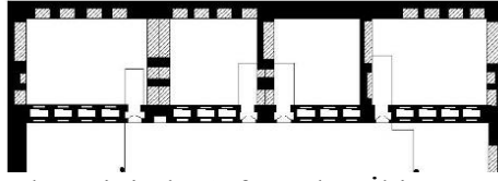
Çiz. 3 Dış Sofalı Plan Tipinde Sofanın her İki Ucuna Eklenen Köşk Eyvan Uygulaması, (Eldem, 1968, s.22, Revize Edilmiş Çizim (Cüneyt Özden)
