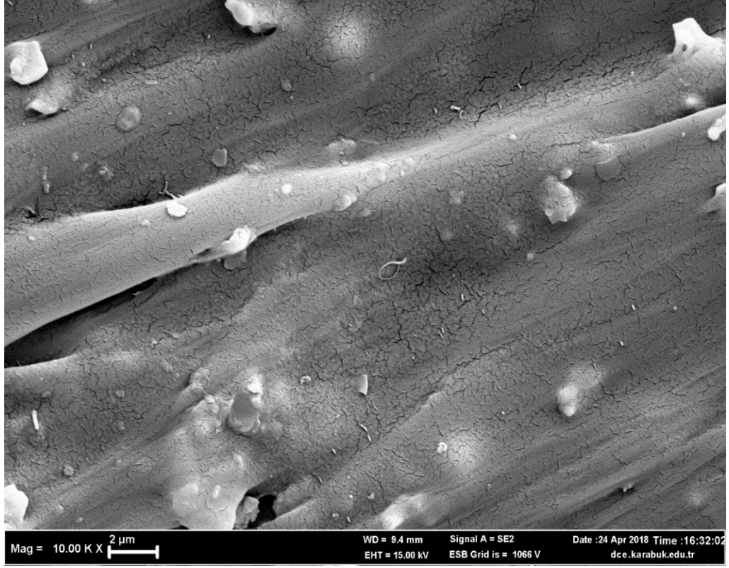
Şekil 6.18. TPU/TAS-Diatomit kompozitinin kırılma yüzeyi görüntüsü.
