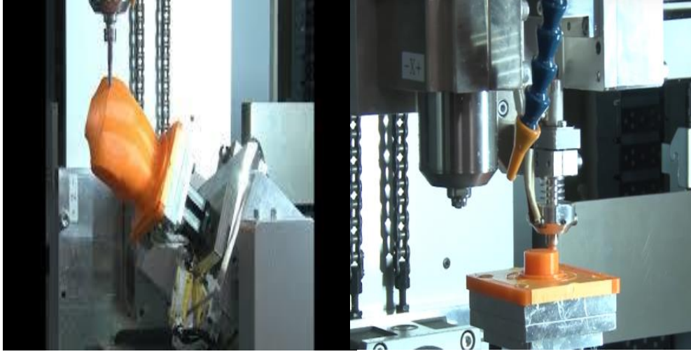
Şekil 2.14. 5 eksen hibrit 3B yazdırma [27].
