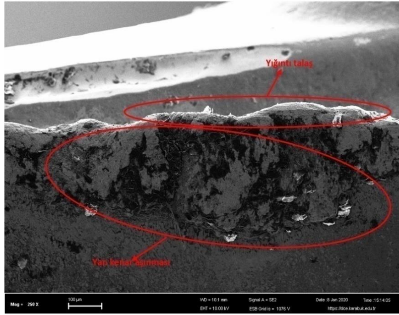
Şekil 6.9. Yığıntı talaş -Yan kenar aşınması SEM görüntüsü.
