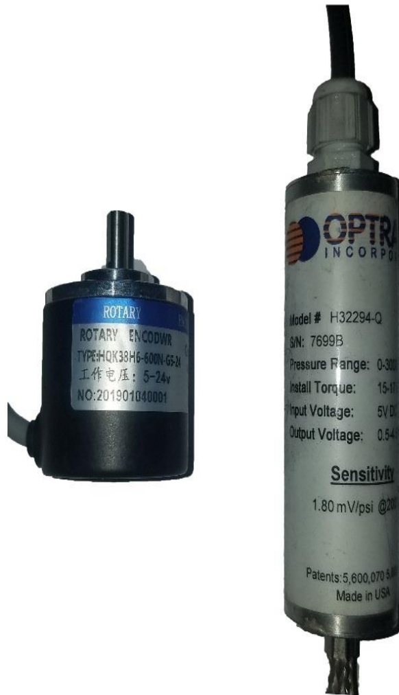
Şekil 5.13. Basınç ve krank açısı sensörlerine ait fotoğraflar.
