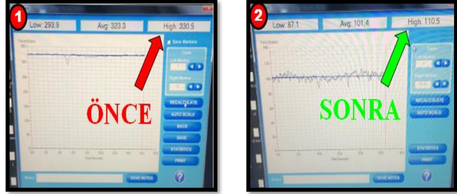
Şekil 5.1. Pre-painted sac üzerindeki streç filmin soyulma esnasında ölçülen kuvvet değerlerini gösteren fotoğraf görüntüsü.
