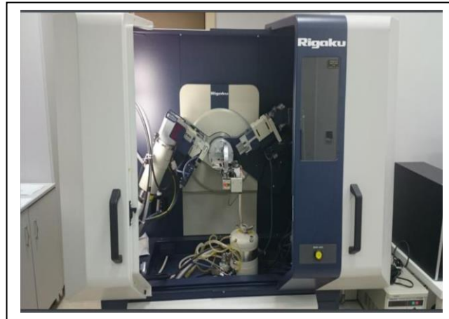
Şekil 5.14. Biyoaktivite deneylerinde kullanılan XRD cihazı.
