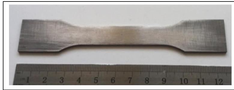
Şekil 5.7. Çekme deney numunesi.
