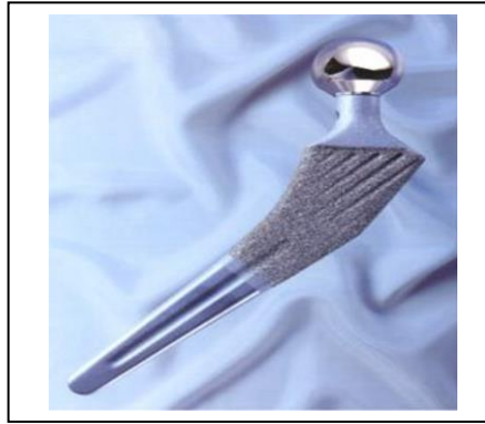
Şekil 3.1. Ti6Al4V alaşım malzemedan üretilmiş implant [53,62].
