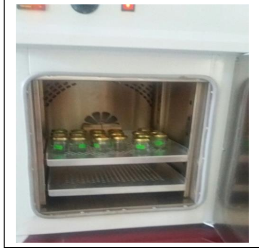
Şekil 5.13. Biyoaktivite deney numunelerinin etüv fırın içerisinde bekletilmesi.
