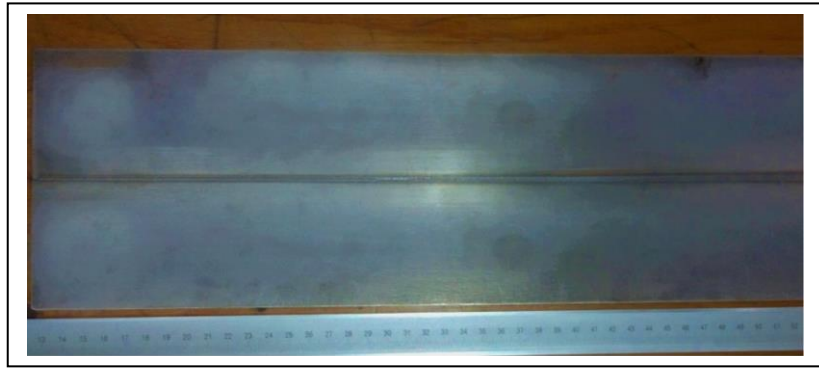
Şekil 5.2. CO 2 lazer kaynaklı Ti6Al4V birleştirmesi.
