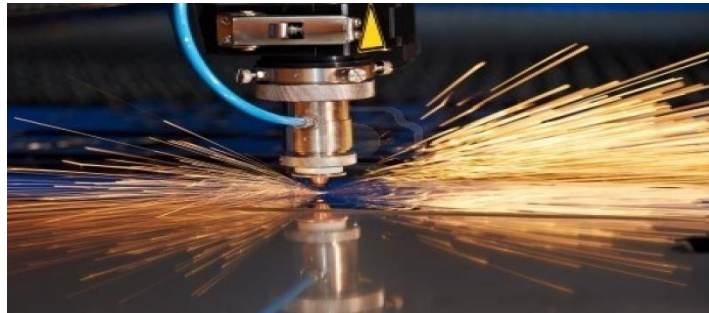
Şekil 4.4. CO 2 lazer kaynağı sistemi [143].
