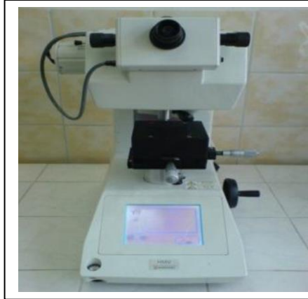
Şekil 5.9. Deneyde kullanılan sertlik ölçüm cihazı.
