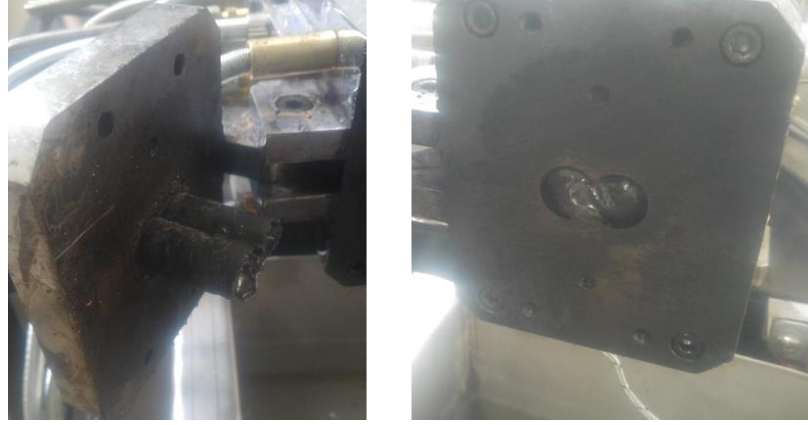
Şekil 6.3. Tıkanan çift vidalı ekstrüder kalıp görüntüsü.
