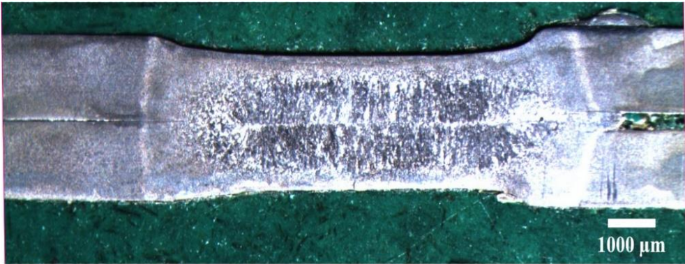
Şekil 6.16. 9 kA kaynak akımlarında kaynaklanan DP1000 çeliğinin makro görüntüsü.
