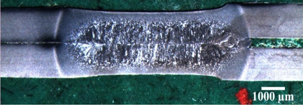
Şekil 6.15. 8 kA kaynak akımlarında kaynaklanan DP1000 çeliğinin makro görüntüsü.
