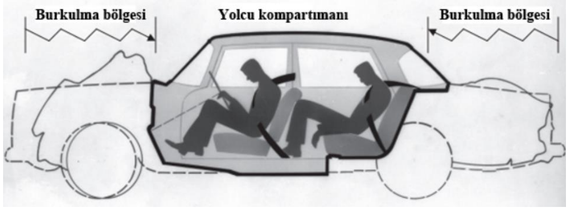
Şekil 2.4. Otomobilde burkulma bölgeleri ve güvenli bölge olan yolcu kompartımanını [36].
