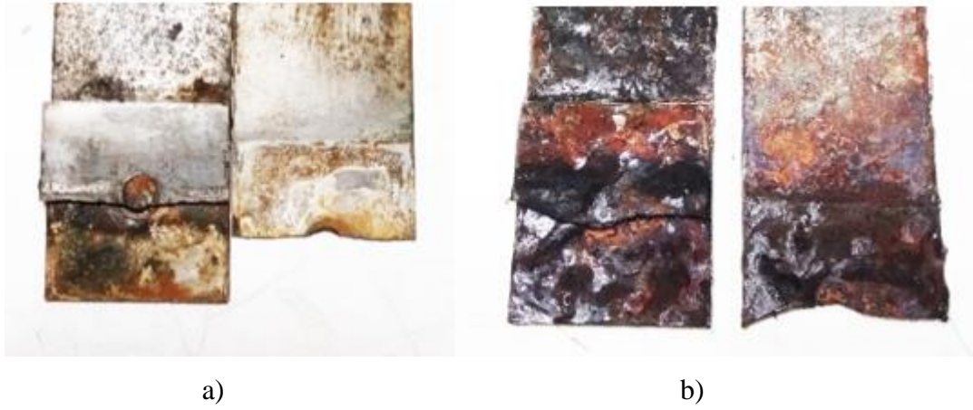
Şekil 6.49. Farklı genliklerde korozyonlu yorulma testlerine tabi tutulan nokta direnç kaynaklı DP1000 çelikleri; a) yüksek genlik, b) düşük genlikli korozyonlu yorulma numunesi.
