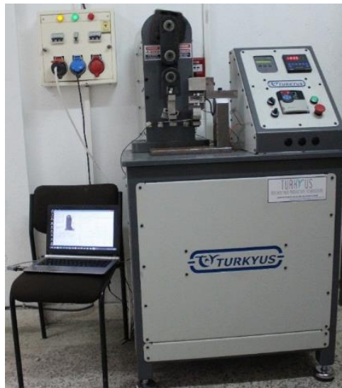
Şekil 5.10. Özel amaçlı yorulma cihazı.
