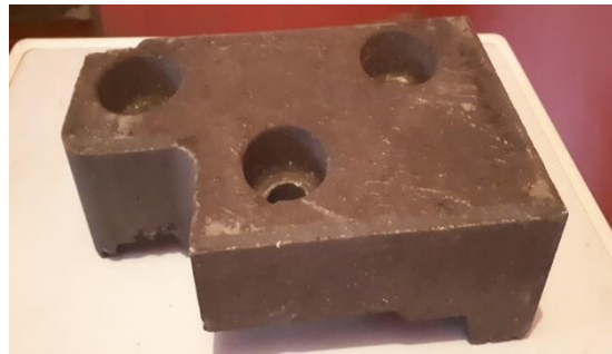
Şekil 2.4. Çamaşır makinası üst beton blok.
