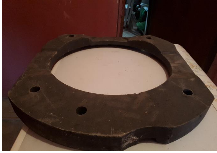
Şekil 2.5. Çamaşır makinası ön beton blok.
