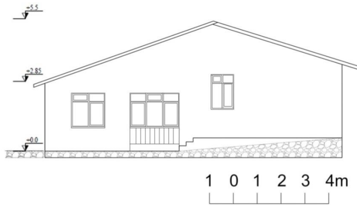
Şekil 5.31. 5000 Evler, C tipi konut sol yan cephesi.
