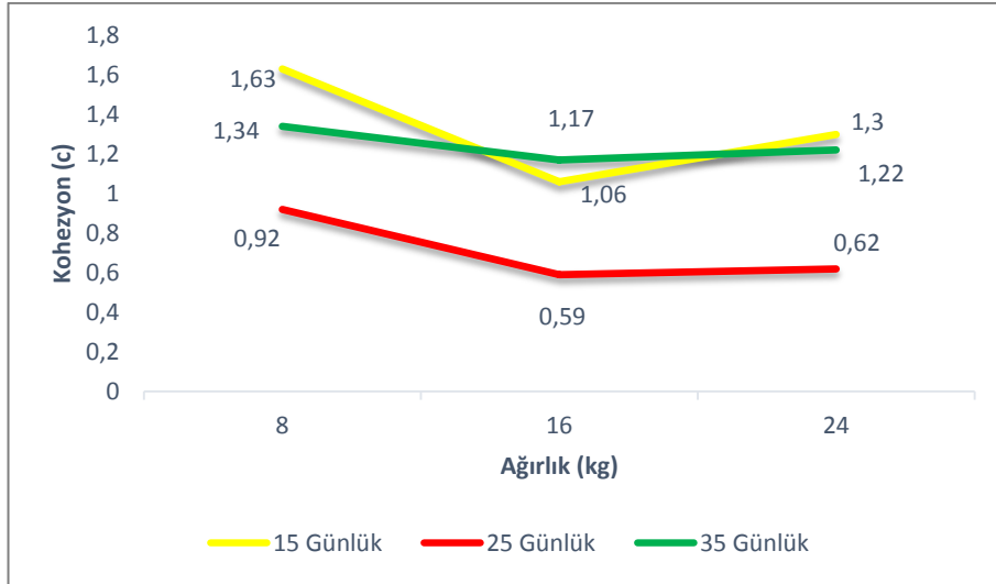
Şekil 3.64. Gerilmeye bağlı olarak kohezyondaki değişim (%18 su içeriğinde 15, 25 ve 35 gün bekleyen %70 kil %30 kum numuneler).
