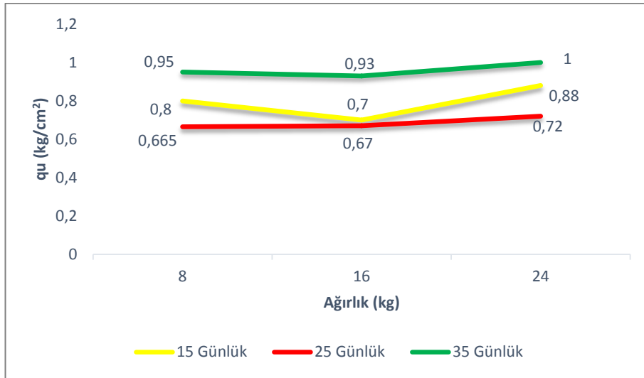
Şekil 3.42. Gerilmeye bağlı olarak ( q_u )'daki değişim (%38 su içeriğinde 15, 25 ve 35 gün bekleyen %70 kil %30 kum numuneler).
