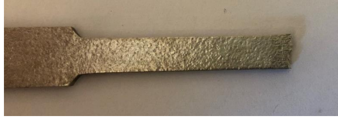
Şekil 4.22. Oluşan portakal kabuğu görünümü.
