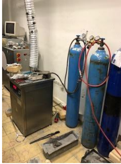
Şekil 3.2. Döküm ocağı ve kullanılan gaz tüpleri ( \text{CO}_2 + \%0.8 \text{ SF}_6 , Argon).
