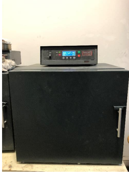
Şekil 3.12. MAGMATHERM marka ve MT 1205-B2 model ısıtma fırını.
