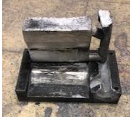
Şekil 3.3. Y şeklinde kalıp ve dökülmüş ZM21 magnezyum alaşımı.
