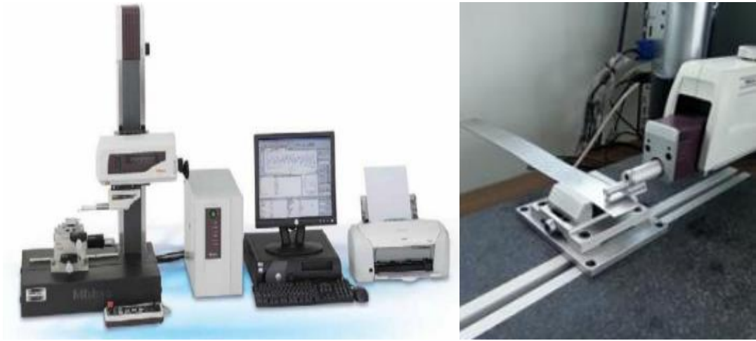
Şekil 3.9. Mitutoyo SJ-410 model yüzey pürüzlülük ölçme cihazı ve ölçüm anına ait görüntü.
