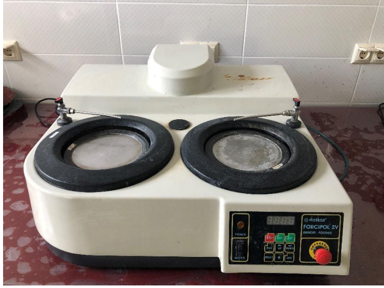
Şekil 3.13. metkon FORCIPOL 2V zımpara ve parlatma cihazı.
