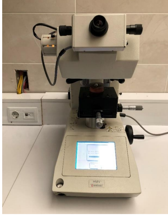
Şekil 3.18. Shimadzu HMV Micro Hardness Tester cihazı.
