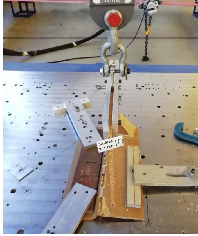
Şekil 3.21. Tenon mortise birleştirme, T tipi bağlantılı 10 mm kalınlığındaki test kuponu.
