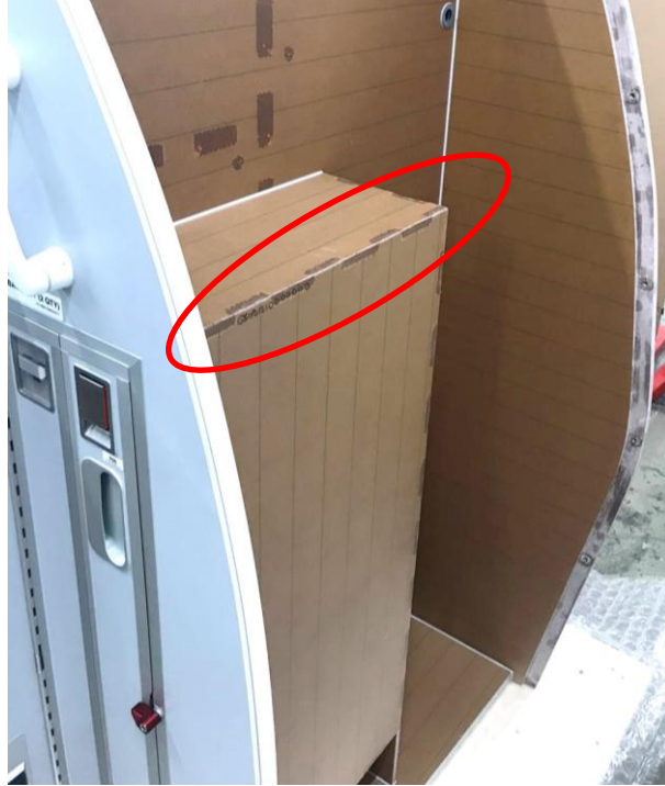
Şekil 2.9. Boeing 737 G7 galleyi tenon mortise birleştirme yöntemi uygulaması.
