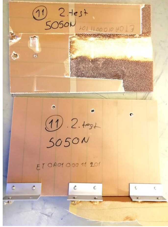
Şekil 4.13. Çift taraf braket, T tipi bağlantılı 10 mm kalınlığındaki test sonrası.
