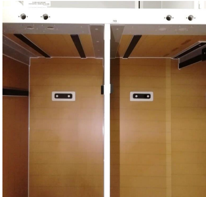
Şekil 2.14. Boeing 737 G7 galleyi braket birleştirme yöntemi uygulaması.
