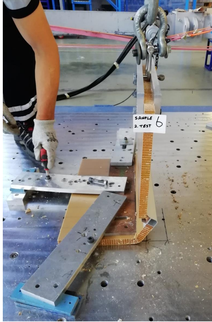
Şekil 3.18. Ekstrüzyon birleştirme, L tipi bağlantılı 22 mm kalınlığındaki test kuponu.
