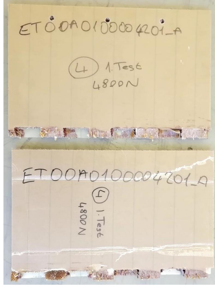
Şekil 4.3. Tenon mortise, L tipi bağlantılı 22 mm kalınlığındaki test sonrası.
