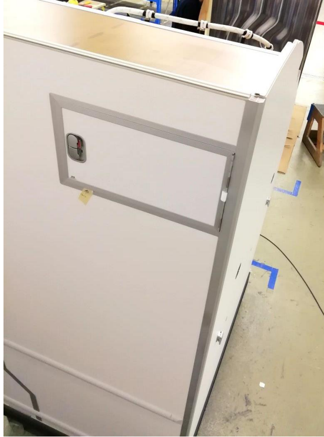
Şekil 2.20. Boeing 737 G2 galleyi ekstrüzyon birleştirme yöntemi uygulaması.
