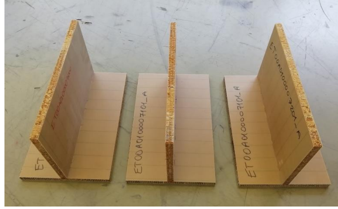
Şekil 3.19. T tipi bağlantı montajları hazırlanmış Tennon-Mortise birleştirmeler.
