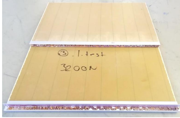
Şekil 4.7. Ekstrüzyon, L tipi bağlantılı 10 mm kalınlığındaki test sonrasında.
