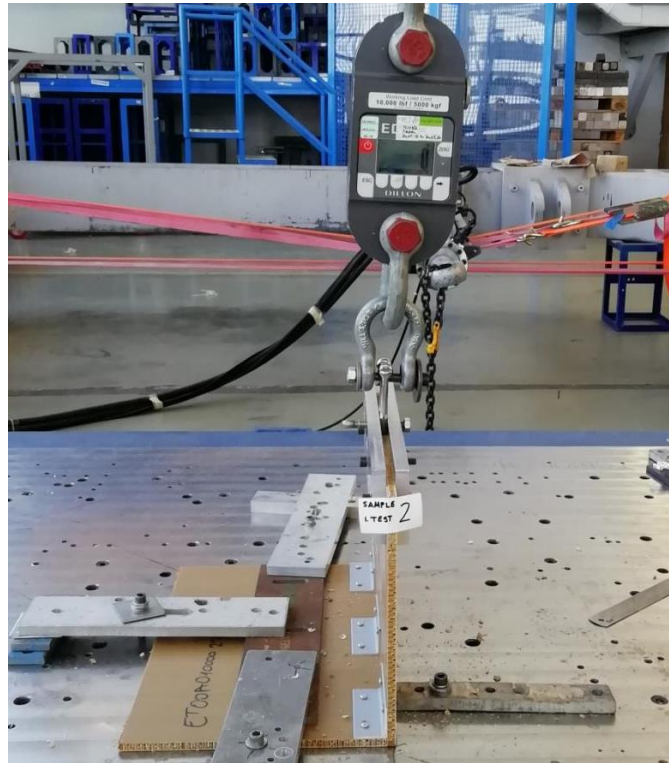
Şekil 3.15. Braket birleştirme, L tipi bağlantılı 10mm kalınlığındaki test kuponu.
