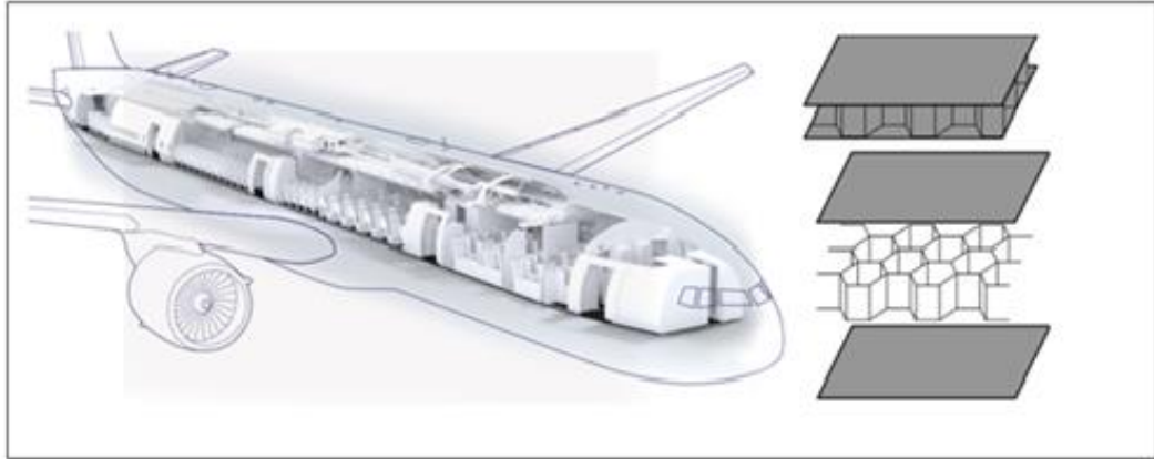
Şekil 2.22. Sandviç yapılı kompozitlerin sivil havacılık sektöründe kullanımı.
