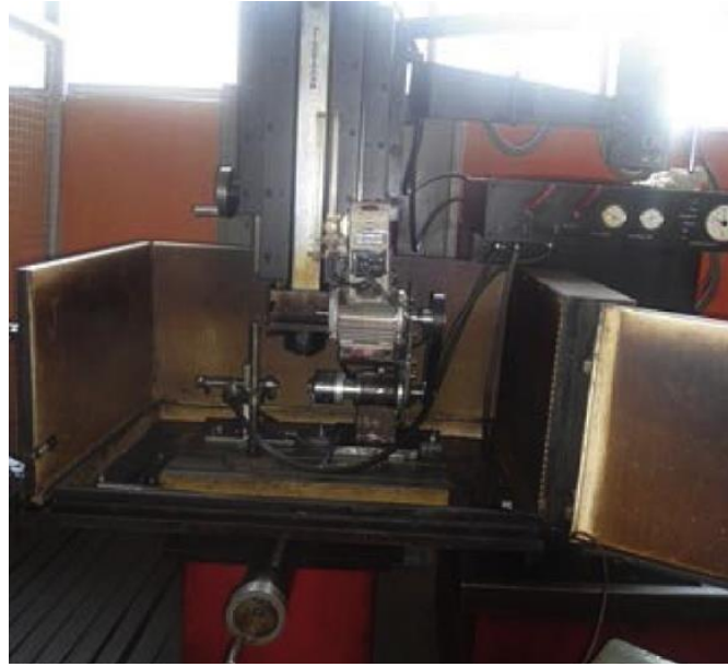
Şekil 2.8. Elektro erozyon ile tornalama deney düzeneği [27].
