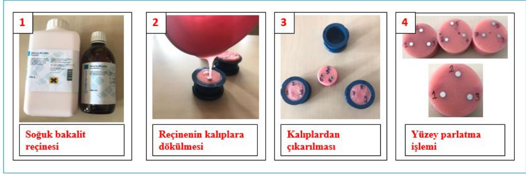
Şekil 4.5. Soğuk bakalite alma işlem sıralaması.
