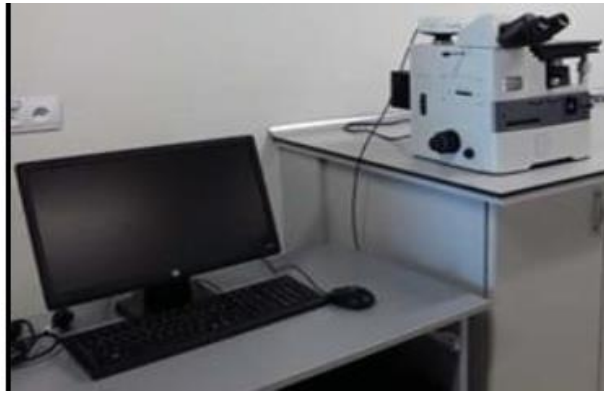
řekil 4.11. Nikon ters metalurjik mikroskopun gsterimi.
