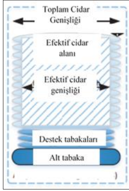
Şekil 4.7. Tel ark eklemeli imalatta efektif cidar genişliğinin gösterilmesi [25].
