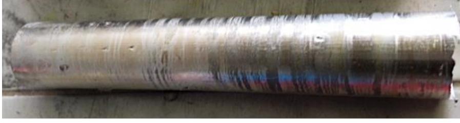
Şekil 3.2. Magnezyum esaslı alaşımların kalıptan çıktıktan sonraki görüntüsü.
