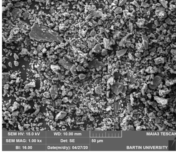
Şekil 7.42. S15 no'lu numunenin 1.5 m/s kayma hızında 40 N yük altında gerçekleştirdiği deney sonrasında yüzeyinden kopan debrisin 1000X büyütme altında çekilen SEM görüntüsü.
