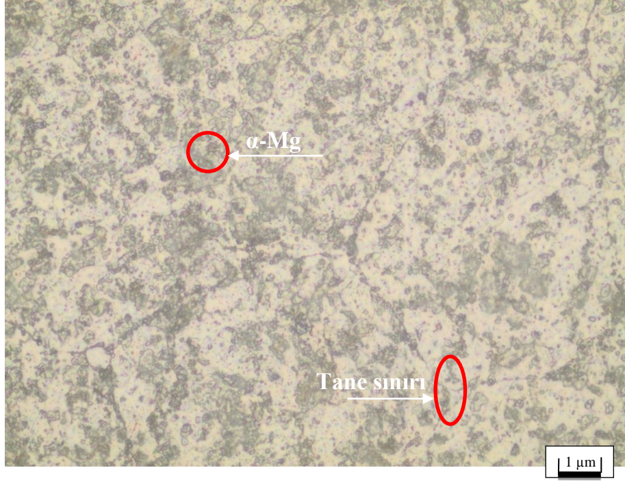
Şekil 7.11. S4 numunesinin 500x büyütülmüş optik mikroskop görüntüsü.
