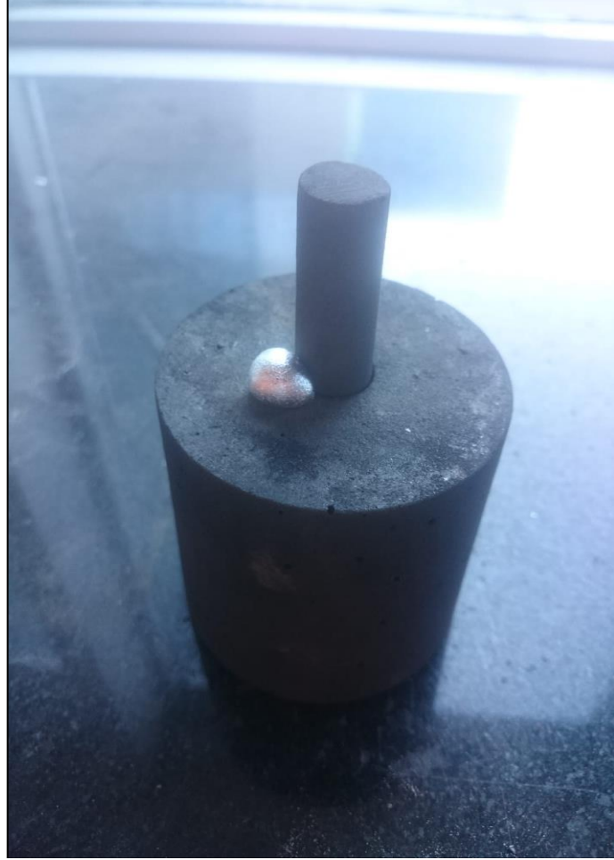
Şekil 6.7. 600C 0 deki numunelerde oluşan kısmi ergime.
