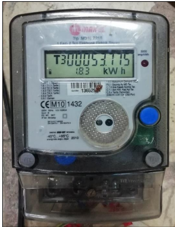
Şekil 4.27. Makel M310.2218, tek fazlı, elektronik elektrik sayacı
